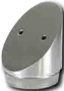
Edelstahl-Abschlußkappe 45° für Ø48 mm Rundrohre mit 2 mm Wandung. Artikel 130.104.48 kommt mit 2 Gewindebohrungen M5 x 5 mm zum Anbringen von Platten für z.B. Rednerpulte, Rasenschilder oder Parkausweisungen.
