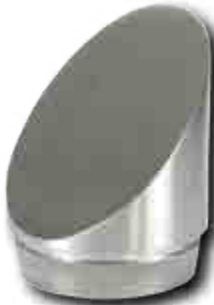
Edelstahl-Abschlußkappe 45° für Ø48 mm Rundrohre mit 2 mm Wandung. Artikel 130.104.48 kommt mit 2 Gewindebohrungen M5 x 5 mm zum Anbringen von Platten für z.B. Rednerpulte, Rasenschilder oder Parkausweisungen.
