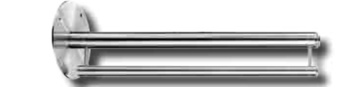
Outdoor-Bannerhalter, bestehend aus 43 mm Tragrohr und 27 mm Spannrohr, komplett mit runder 200 x 5 mm Montagescheibe mit vier zylindrischen 10 mm Bohrungen für Wandmontage, 2 unsichtbaren Inbus-Spannschrauben M 8 x 70 mit versenktem Kopf und mind. 35 mm Spannbereich.
