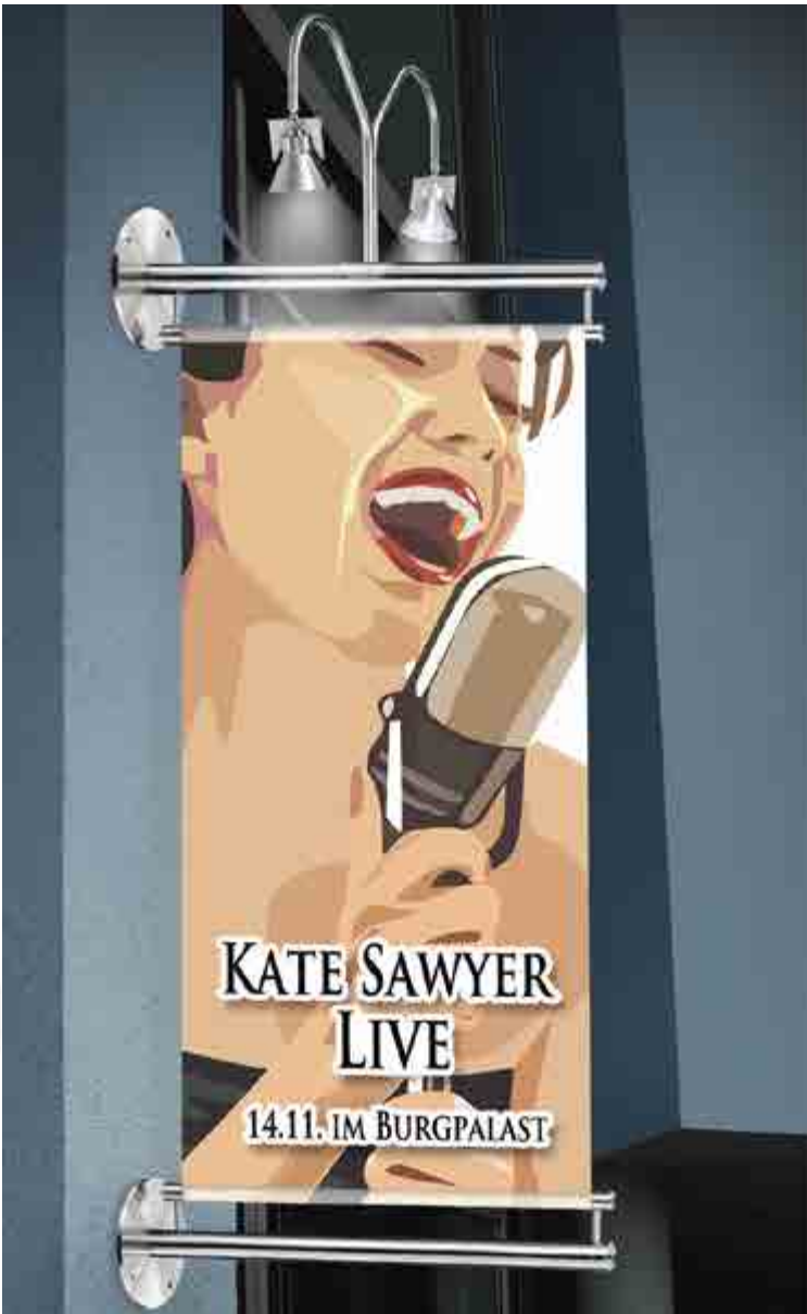
Outdoor-Bannerhalter, bestehend aus 43 mm Tragrohr und 27 mm Spannrohr, komplett mit runder 200 x 5 mm Montagescheibe mit vier zylindrischen 10 mm Bohrungen für Wandmontage, 2 unsichtbaren Inbus-Spannschrauben M 8 x 70 mit versenktem Kopf und mind. 35 mm Spannbereich.
